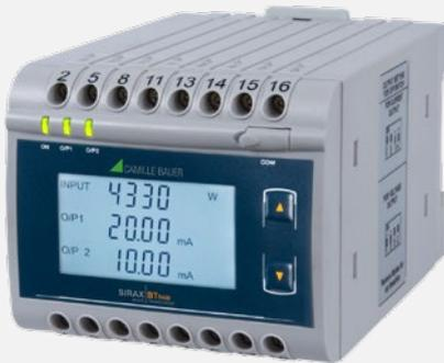
Der SIRAX BT5400 wird zur Messung und Umwandlung von Wirkleistung, Scheinleistung, Blindleistung, Phasenwinkel und Leistungsfaktor einphasiger oder dreiphasiger AC-Systeme mit symmetrischer oder asymmetrischer Last in ein proportionales Gleichstrom- oder Gleichspannungsausgangssignal eingesetzt.
