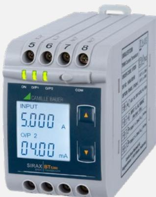
Der Messumformer SIRAX BT5200 ist ein DIN Rail Hutschienengerät das zur Umwandlung eines AC-Eingangsstromes in ein dem Messwert proportionalem DC-Strom- oder Spannungsausgangssignal dient. Der AC-Eingangsstrom und der Ausgangsstrom/ Spannung werden auf dem Display angezeigt und auf der Modbus-Schnittstelle abgebildet.
