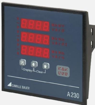
Das Anzeigegerät A230 im Format 144 x 144 x 46 mm ist für den Schaltschrankbau konzipiert. Mit seiner 4-Quadranten-Messung ist es für die Netzdung Verbrauchsanalyse in ein- und mehrphasigen Wechselstromnetzen geeignet.
