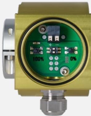
**Erfasst kontaktlos die Winkelstellung einer Welle und formt sie in einen eingepprägten, dem Messwert proportionalen Gleichstrom um.**
