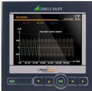
Der LINAX PQ1000 kombiniert die Eigenschaften eines normativen PQ-Messgerätes mit Funktionen für die Energieverbrauchs- und Netzzustandsanalyse. Das moderne, mehrsprachige Design erlaubt das Gerät intuitiv über die Geräte-Website oder das hochauflösende Farb-TFT Display (320x240px) zu bedienen oder zu parametrieren. Der integrierte Webserver ermöglicht die Fernabfrage, Anzeige und Analyse der Messdaten. Es ist keine zusätzliche Software erforderlich.
