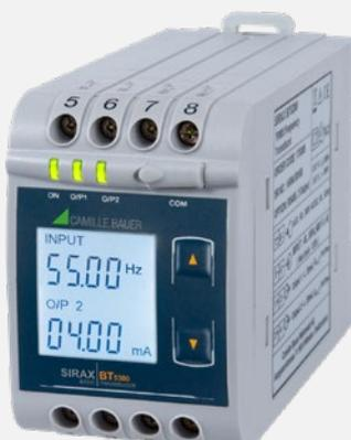
Der Messumformer SIRAX BT5300 ist ein DIN Rail Hutschienengerät das zur Umwandlung einer Eingangsfrequenz in ein dem Messwert proportionalem DC-Strom- oder Spannungsausgangssignal dient. Die Eingangsfrequenz und der Ausgangsstrom/ Spannung werden auf dem Display angezeigt und auf der Modbus-Schnittstelle abgebildet.
