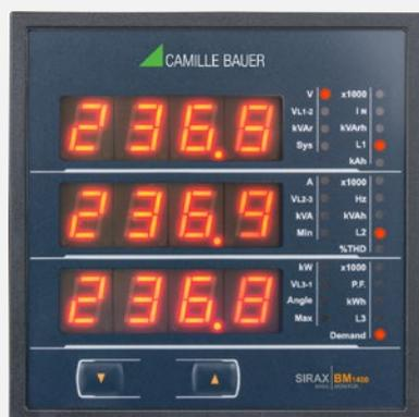
Das universelle Messgerät SIRAX BM1400 ist für Festmontage und die Messung von Spannung, Strom, Frequenz, Leistung, Energie (Wirk-, Blind- und Scheinenergie), Leistungsfaktor, Phasenwinkel, usw. in Niederspannungsschaltanlagen geeignet. Die Geräte sind für asymmetrische Last in Drei-Phasennetzen mit 3- oder 4-Drahtanschluss konstruiert
